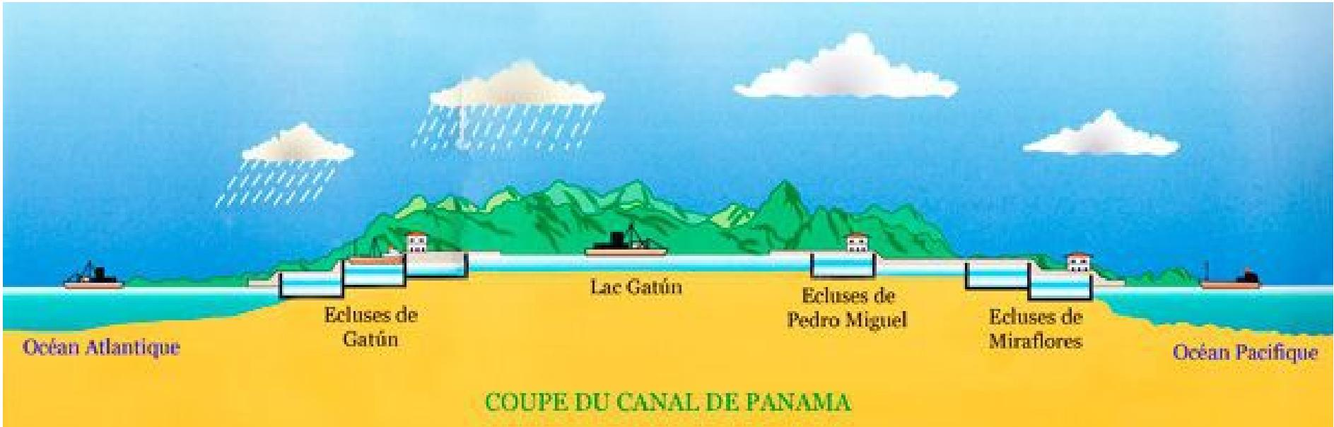
Le Canal de Panama est un canal d'eau douce. Le lac Gatun fournit en eau les écluses qui se remplissent par gravitation. Chaque éclusage engendre une perte en eau douce qui se déverse dans l'Océan. Ce système « à eau perdue » implique la consommation de 2 millions de mètres cubes d'eau pour le passage d'un cargo d'Océan à Océan(...)
