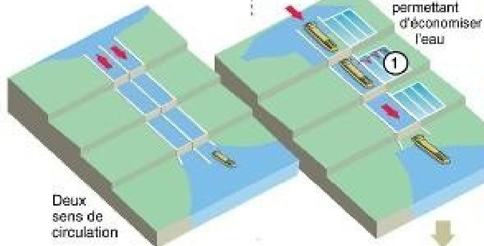
① L'eau est transférée par gravité aux bassins de récupération pour une utilisation à l'écluse suivante
